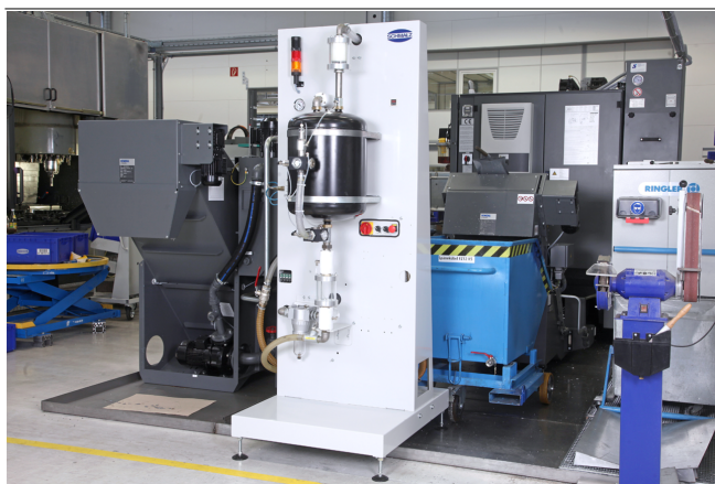
Centrales de vide opérationnelles VOC pour la génération du vide d'usina... en milieu humide
